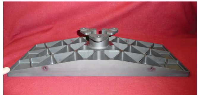
Fig. 5. M1 mirror blank
